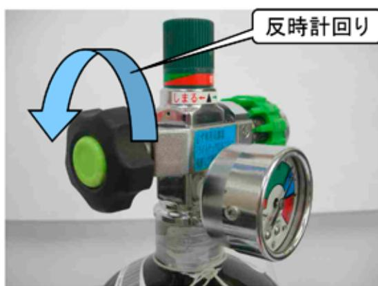
④調整器を外し新しいボンベに付替える。
